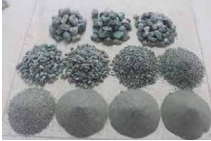
Figura 2 Ejemplo de una buena granulometría de agregados
