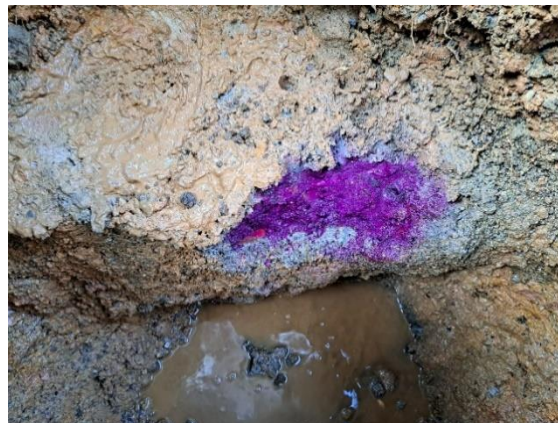
Ilustración 36 Cimentación con 9 Cm de frente de Carbonatación
