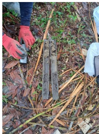
Ilustración 17 Muestra recuperada por medio de cuchara partida en SPT
