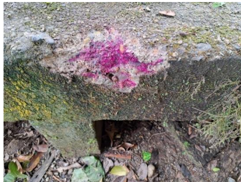
Ilustración 36 Cimentación con 9 Cm de frente de Carbonatación
