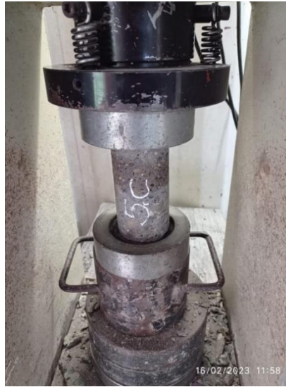
Ilustración 33 Rotura de muestras – ensayo a compresión
