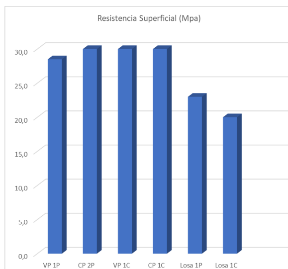
Ilustración 29 Resultados resistencia superficial del concreto con martillo de rebote.
