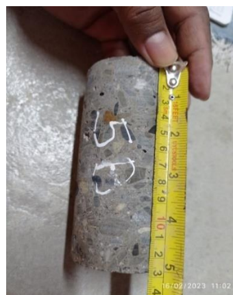
Ilustración 32 Verificación de la geometría de la muestra
