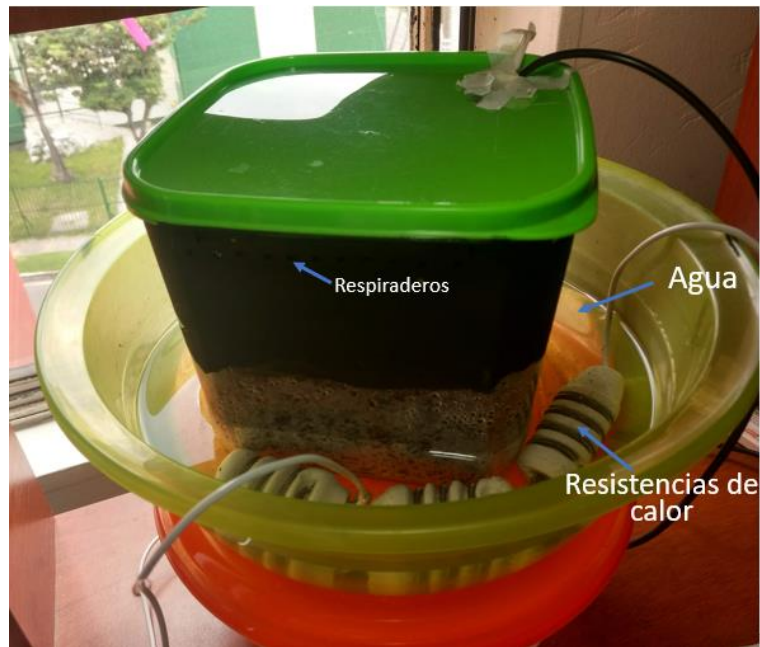
Figura 7. Actuador planta vermicompostaje
