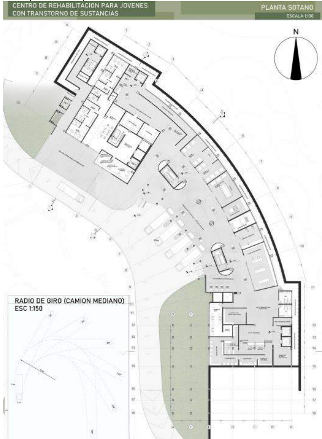
Figura 43. Representación planta sótano del centro de rehabilitación.
