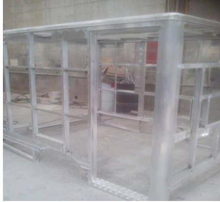
Figura 2 Construcción de la estructura de una carrocería en aluminio
