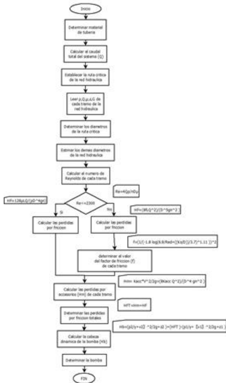
Figura 42 Diagrama de flujo de para el diseño paramétrico del sistema hidráulico
