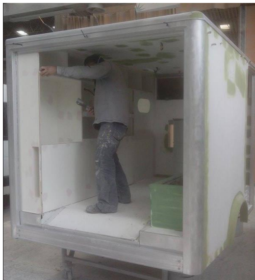
Figura 5 Proceso de pintura de la carrocería
