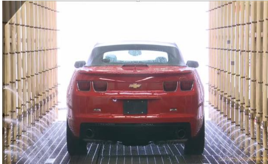
Figura 14 Prueba de impermeabilidad realizada por la empresa Chevrolet
