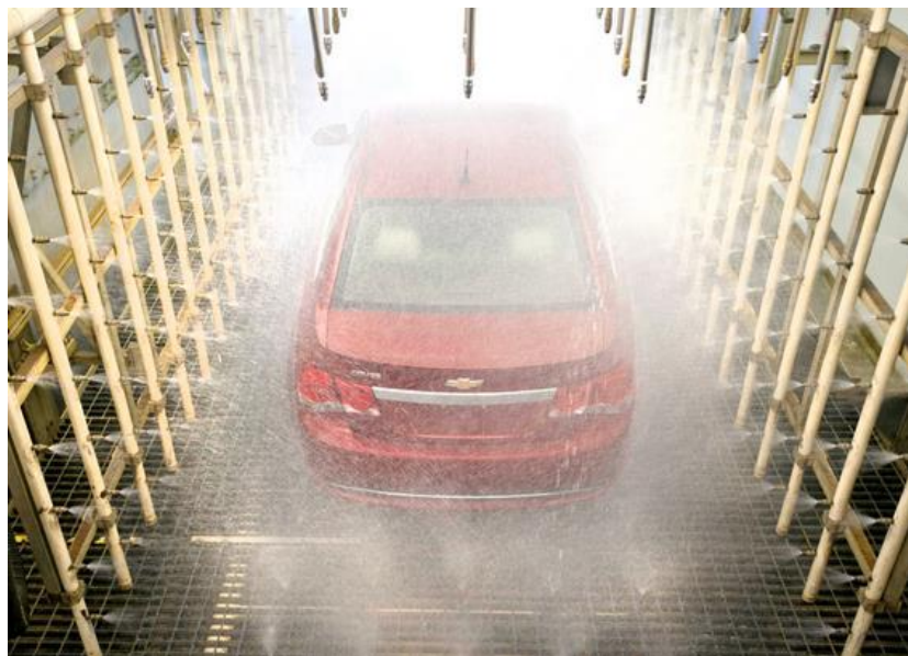
Figura 13 Prueba de impermeabilidad realizada por la empresa Chevrolet
