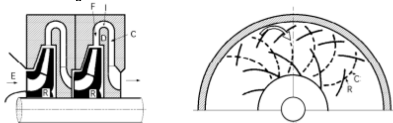
Ilustración 14. TC centrífugo de varios escalonamientos en corte meridional y corte radial.
