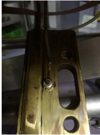
Figura 34. Termocupla tipo J con avería.
