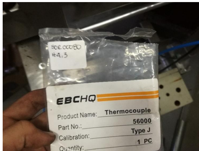
Figura 35. Repuesto termocupla tipo J
