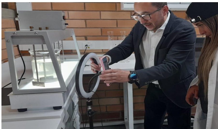
Figura 16. Montaje experimental para la toma de fotografías para la medición de flocs
