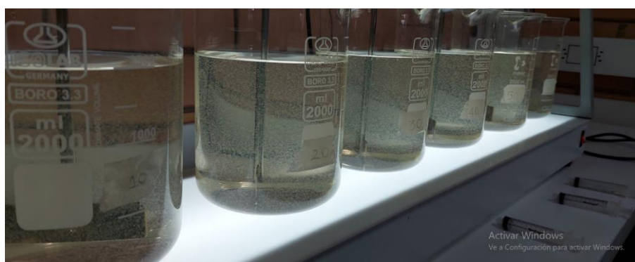
Figura 13. Mezcla a 40 rpm con diferente dosis de coagulante en cada jarra durante 15 min.
