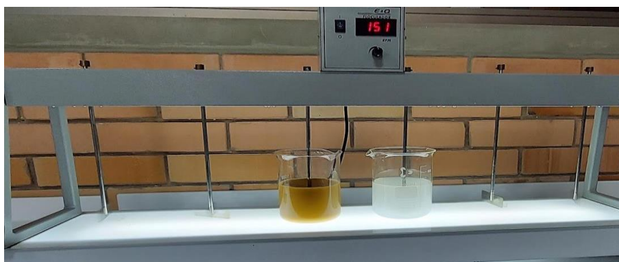
Figura 11. Agitación de la mezcla a 300 rpm durante 20 minutos.
