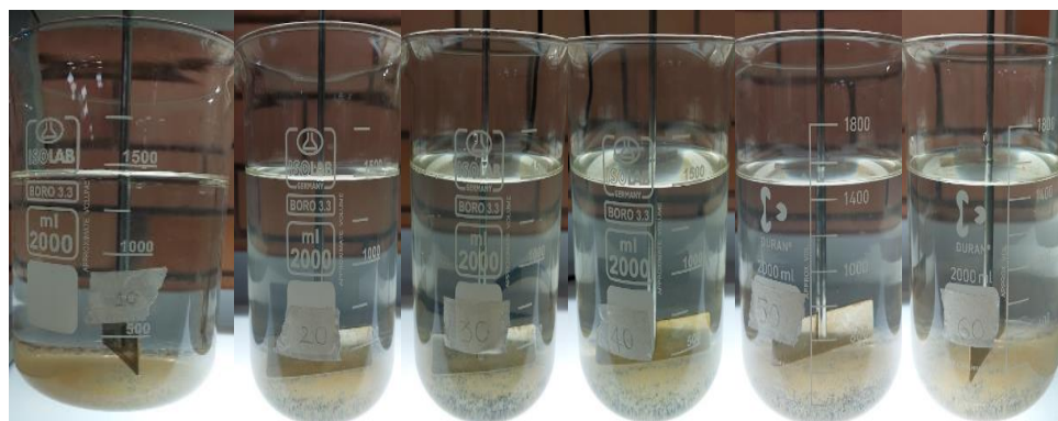
Figura 14. Proceso de sedimentación en cada una de las jarras.
