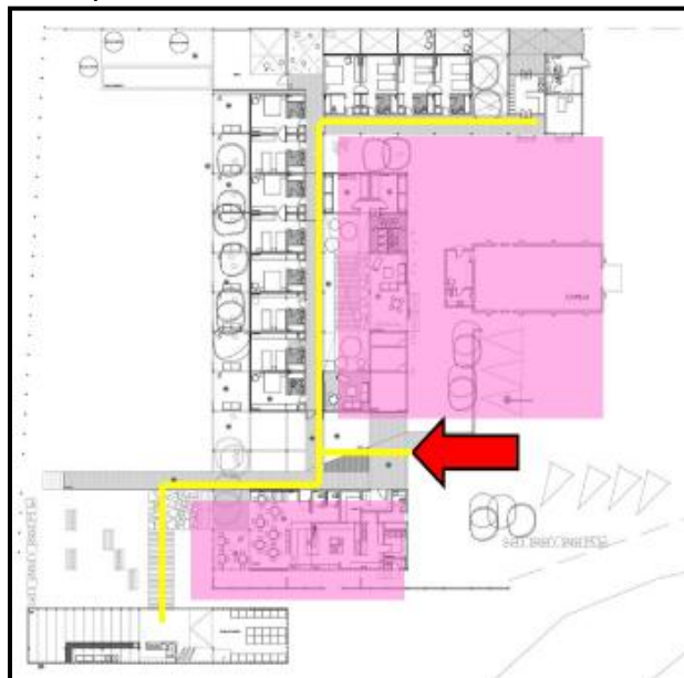
Figura 24. Planta zonificación de circulación
