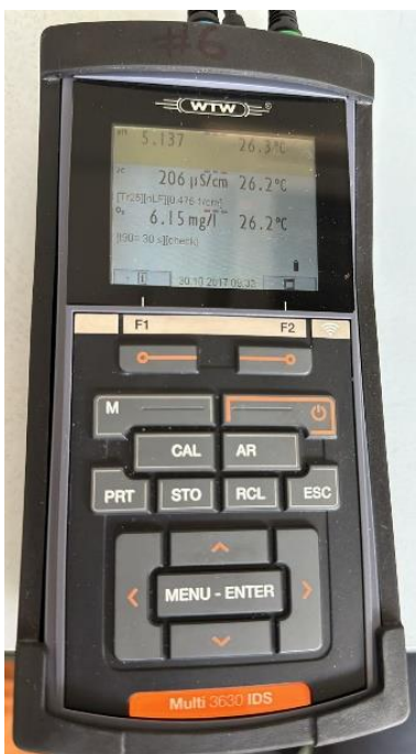
Figura 6. Ensayo multiparámetro para determinar pH, temperatura, conductividad y Oxígeno disuelto
