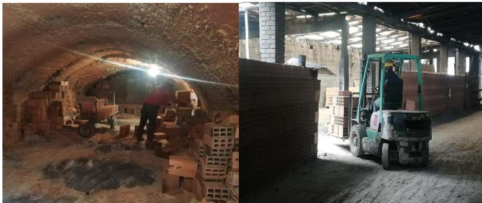
Ilustración 22. Operarios encargados del deshorne y almacenamiento.
