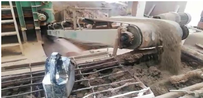
Ilustración 9. Mezcla de agua y arcilla para su homogenización.
