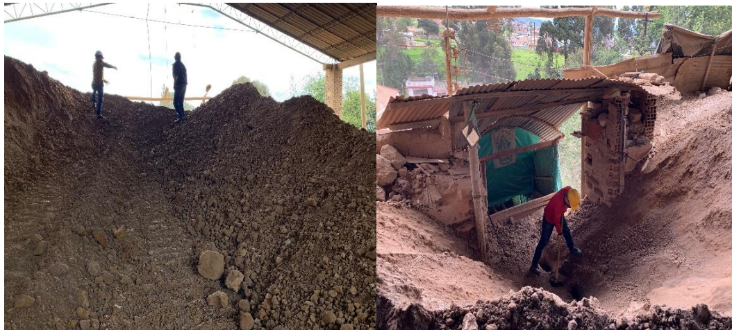
Ilustración 3. Operario encargado del suministro de arcilla al molino de martillo. Ladrillera El Rubi S.A.S
