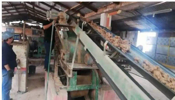
Ilustración 11. Ingreso de la masa para extracción de agua y aire comprimido de la arcilla. Ladrillera El Rubí S.A.S
