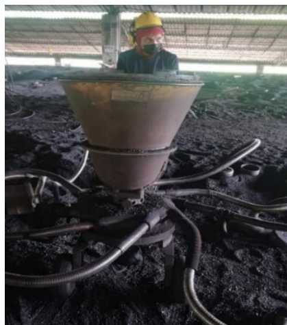
Ilustración 20. Maquina suministradora de carbón mineral “carbojet”.
