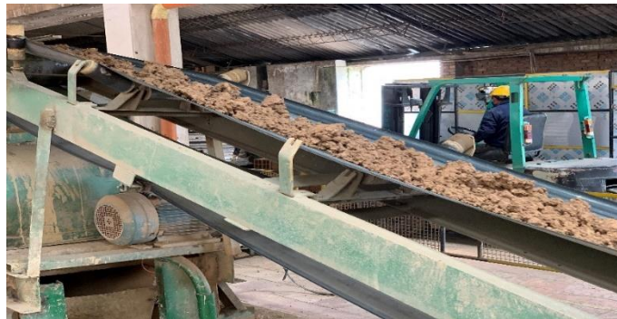
Ilustración 10. Paso de la masa de arcilla luego de su homogenización.
