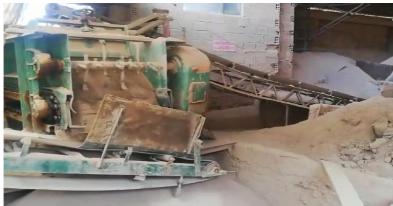
Ilustración 8. Suministro de la materia prima para el mezclador. Ladrillera El Rubí S.A.S
