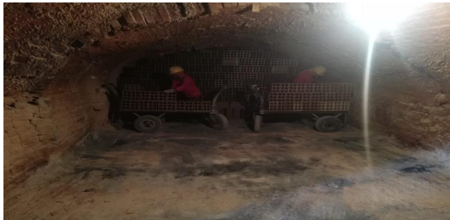
Ilustración 17. Operarios encargados del endague del producto en el horno Hoffman. Ladrillera El Rubí S.A.S
