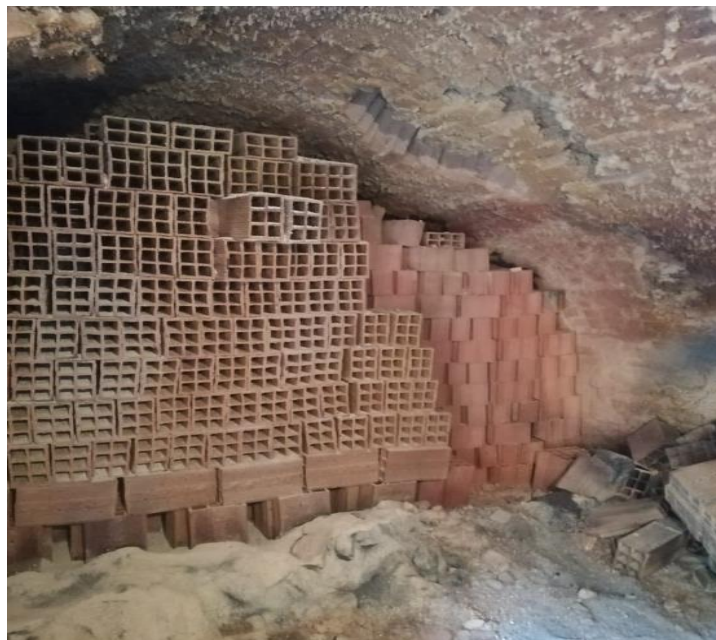
Ilustración 18. Material apilado en el horno para su cocción.
