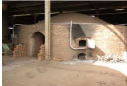
Ilustración 19. Horno tipo Colmena. Ladrillera El Rubí S.A.S
