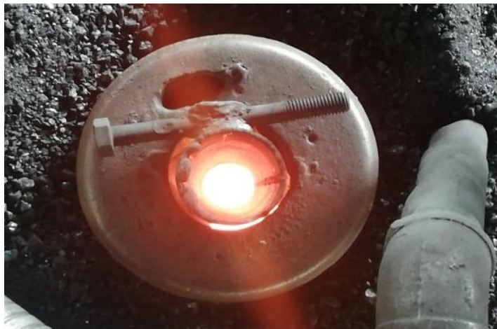
Ilustración 21. Brameras ubicadas en la parte superior del horno
