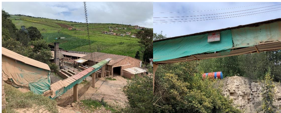
Ilustración 5. Transporte de materia prima por medio de banda transportadora. Ladrillera El Rubí S.A.S
