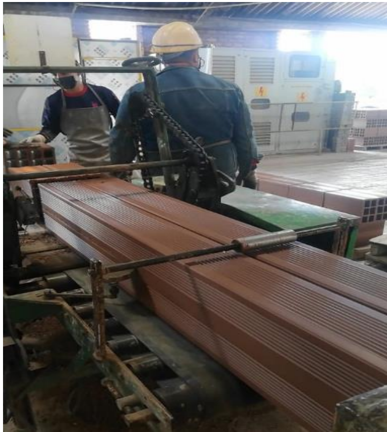
Ilustración 14. Corte del material crudo, Ladrillera El Rubí S.A.S
