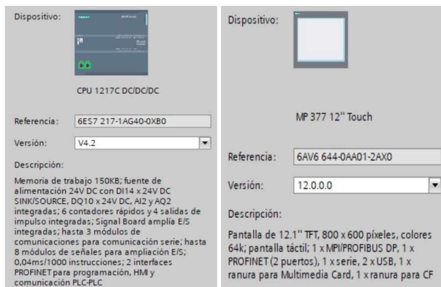
Figura 24. Especificaciones del controlador e interfaz hombre - maquina
