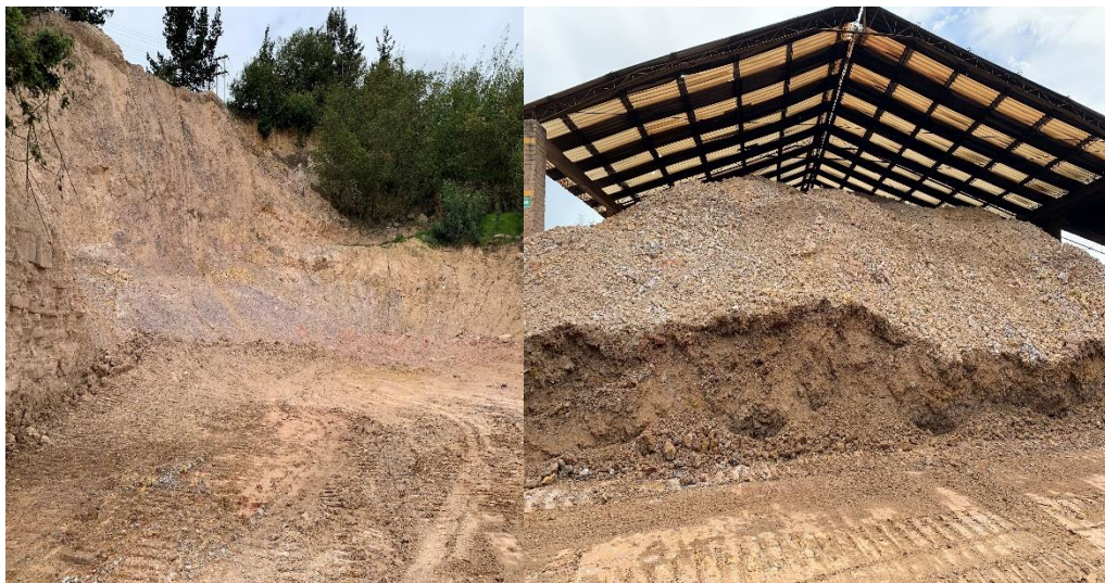
Ilustración 1. Almacenamiento de la materia prima “arcilla”. Ladrillera El Rubi
