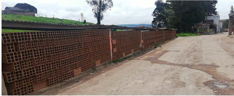
Ilustración 16. Secado natural del producto en ramadas. Ladrillera El Rubí S.A.S
