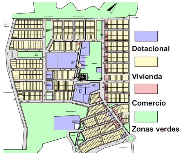
Figura 10 Uso y estado de la construcción aledaña
