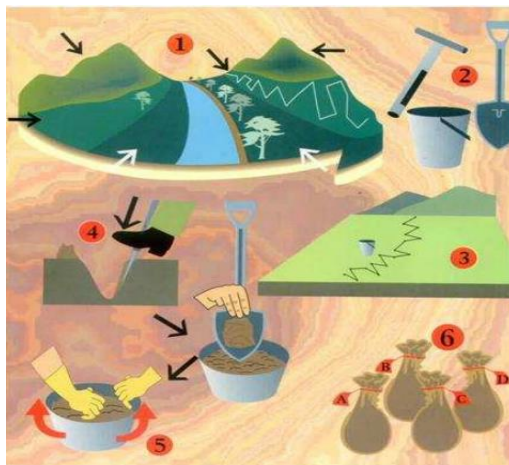
Figura 3. Procedimiento a seguir para la obtención de una muestra compuesta. Adaptado de “IGAC, 2013”; por Medina & Vélez, 2018.
