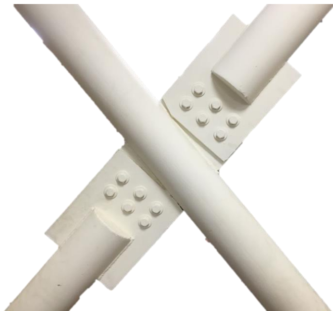
Ilustración 38 Detalle amarre de rigidizadores atornillados a pletina IPS 200
