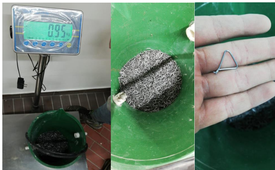
Figura 19 Dosificación de fibras de acero en forma triangular Fuente: Propia
