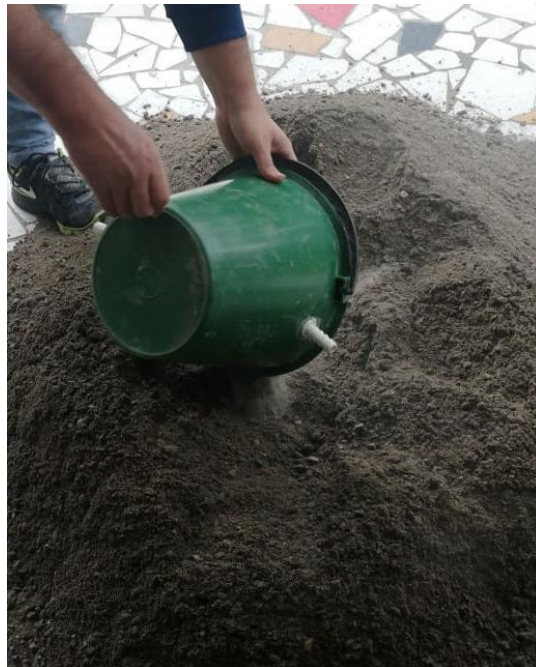
Figura 10 Agregado grueso y fino mezclado proveniente Agremet Fuente: Propia
