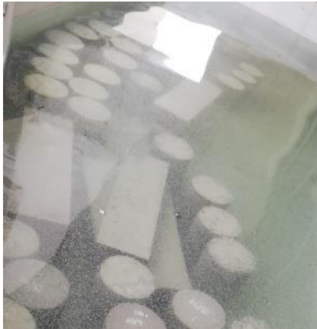
Figura 28 Inicio de proceso de curado viguetas y cilindros Fuente: Propia
