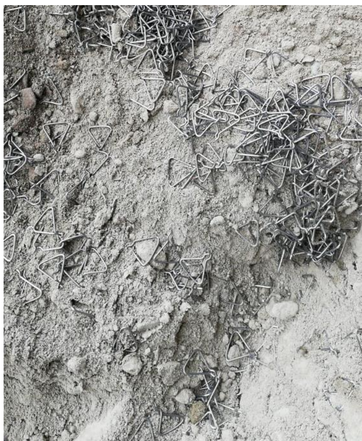
Figura 20 Integración de fibras triangulares con la mezcla de concreto Fuente: Propia
