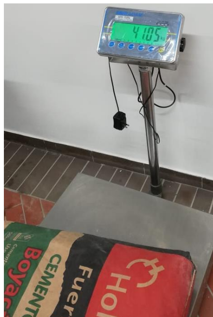
Figura 18 Dosificación cemento Holcim para fibras triangulares
