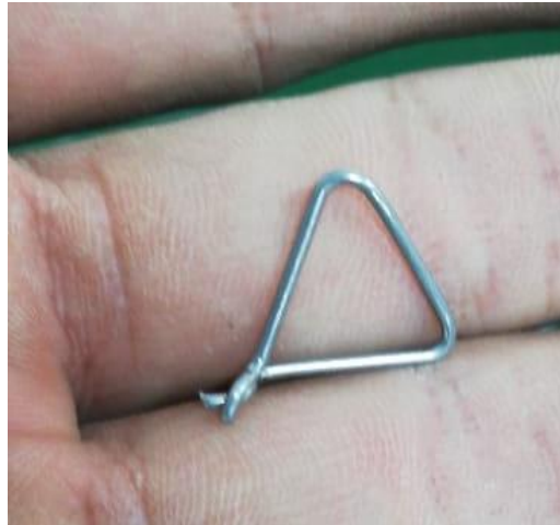
Figura 8 Fibra de acero en forma triangular Fuente: Propia
