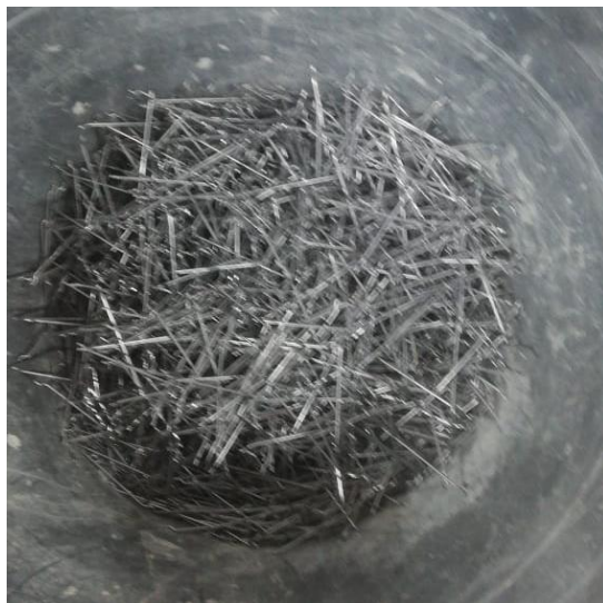
Figura 13 Balde 8 litros con dosificación fibras convencionales Fuente: Propia
