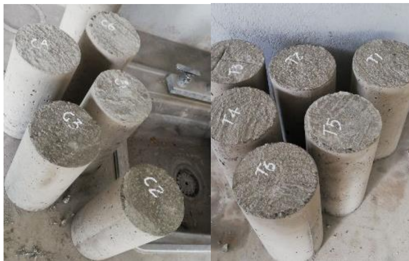
Figura 24 Desencofrado de cilindros Fuente: Propia
