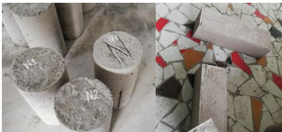
Figura 25 Desencofrado de viguetas y cilindros Fuente: Propia
