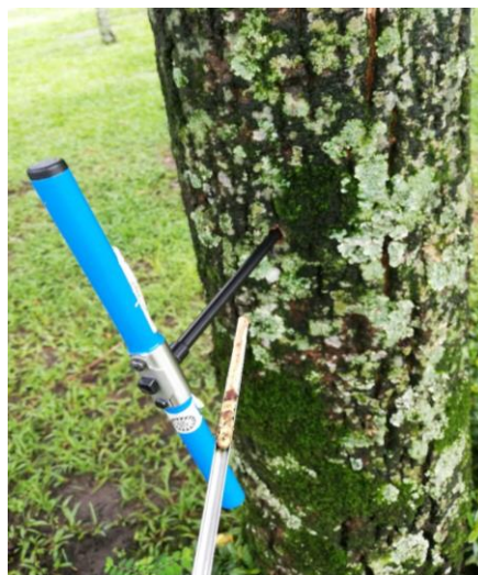
Figura 8. Extracción de un tarugo de madera haciendo uso del barreno de incremento.
