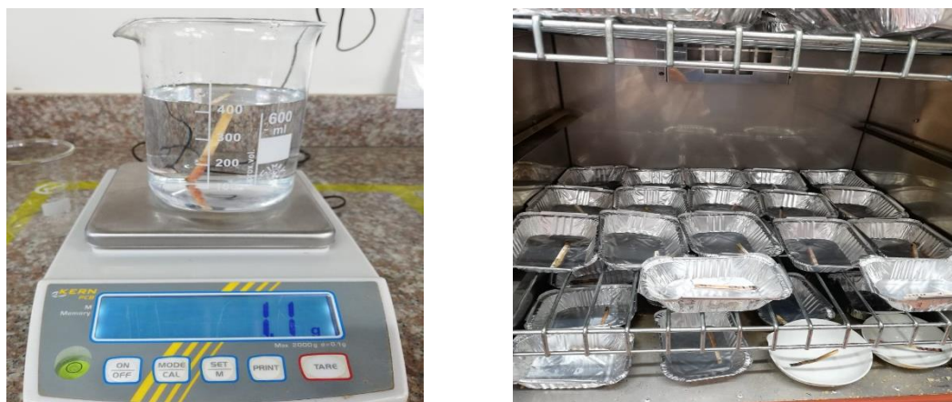
Figura 9. Proceso de obtención de la densidad básica de la madera.
