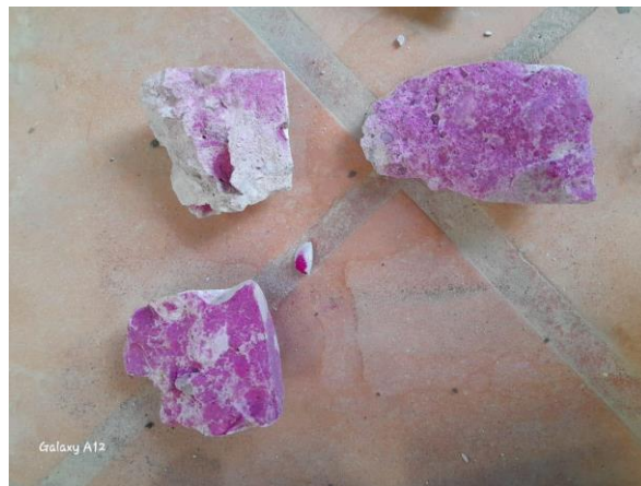
Fig 1 – Ensayo de carbonatación
