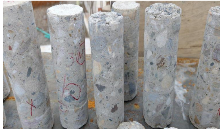
Foto 2 – Nucleos de concreto piscina Casa B5 Barú
