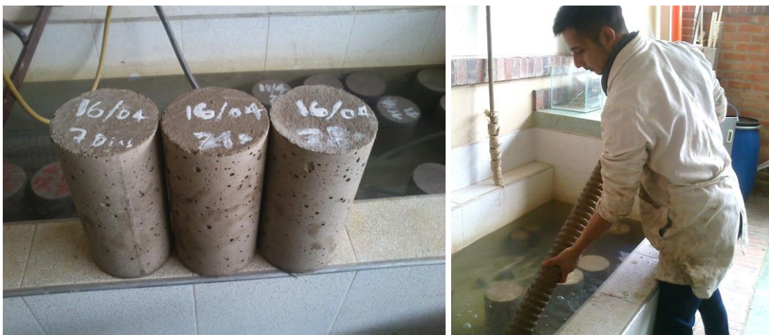
Figura 44. Curado de cilindros y micropilotes de concreto.
