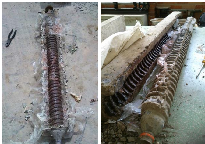
Figura 42. Micropilote extraído del molde de concreto.
