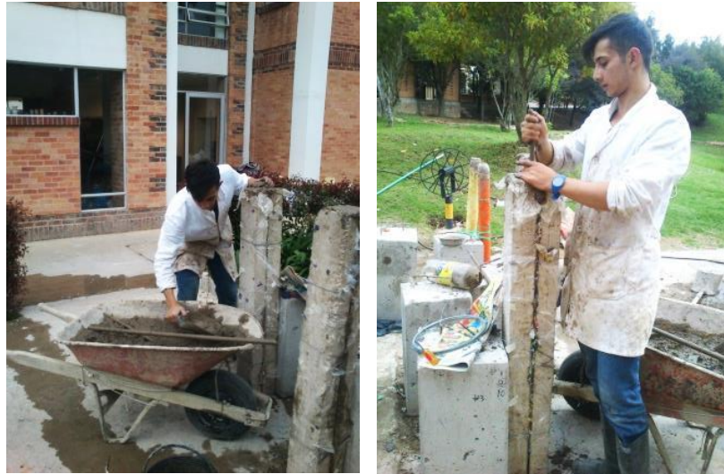
Figura 40. Fundición del concreto dentro de los moldes.
