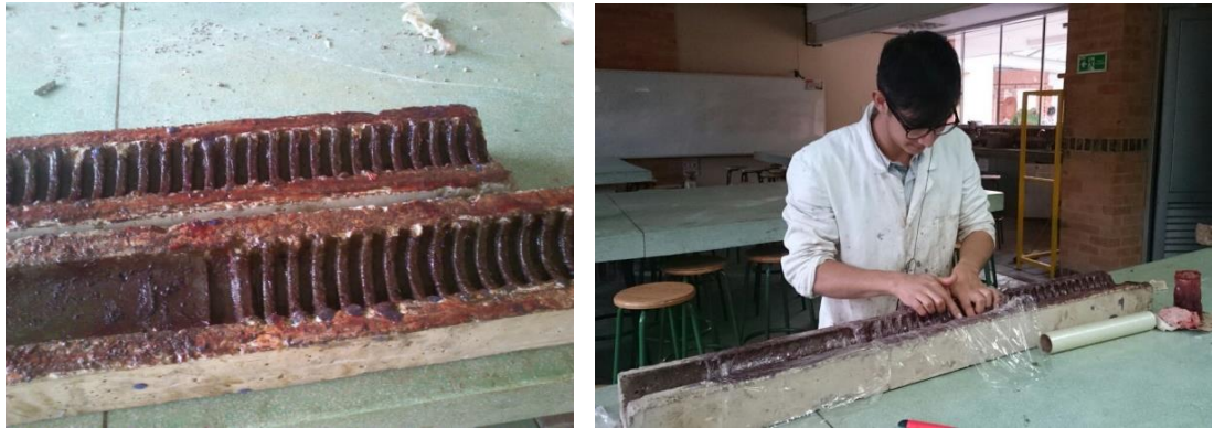
Figura 36. Adecuación de los molde de concreto.
