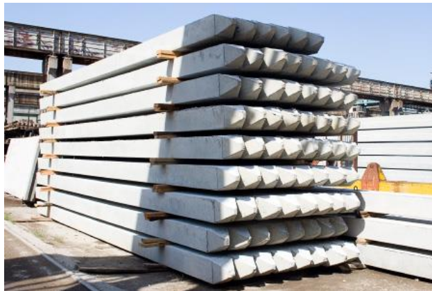
Figura 5. Pilotes prefabricados en concreto de sección transversal cuadrada.
