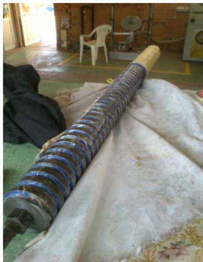
Figura 26. Modelo en acero con las dimensiones establecidas para los micropilotes.
