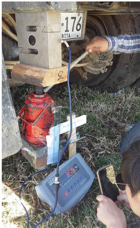
Figura 57. Ejecución de una prueba de carga.
