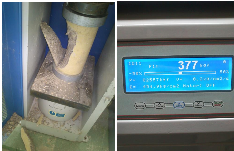
Figura 45. Prueba de compresión a un cilindro de concreto.
