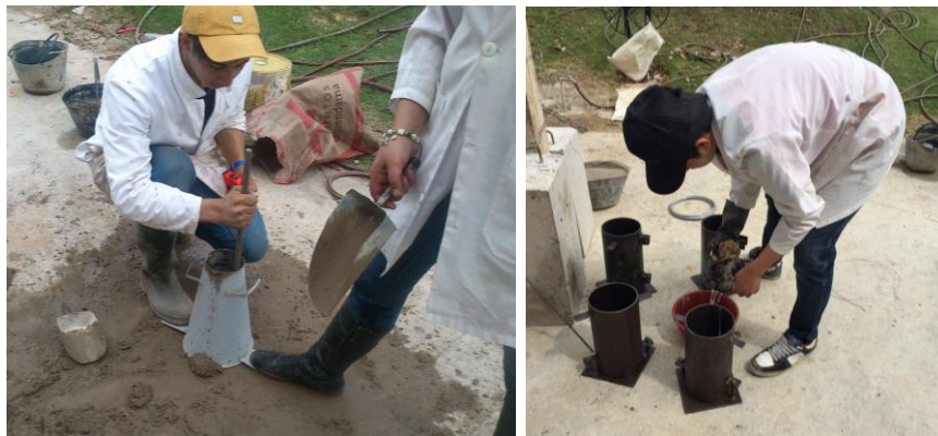
Figura 39. Prueba de asentamiento y elaboración de cilindros de concreto
