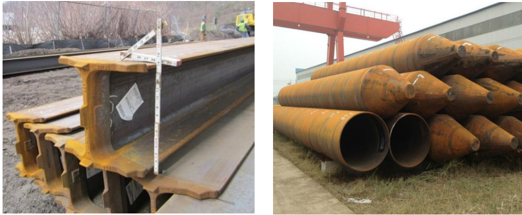
Figura 7. Pilotes en acero con sección H y circulares
