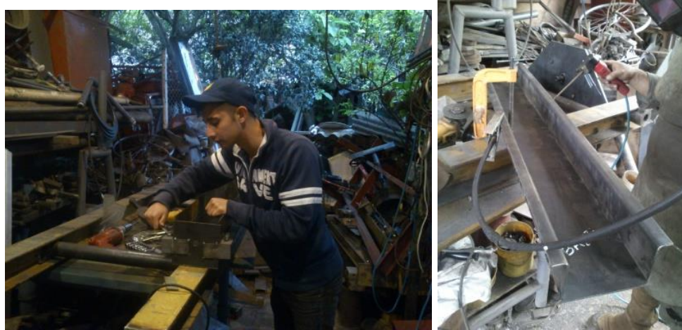
Figura 27. Imágenes del proceso constructivo de la formaleta metálica.
