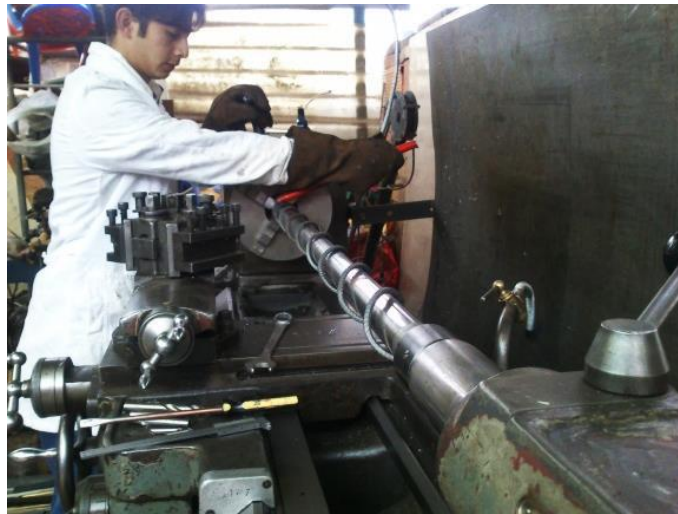
Figura 32. Construcción de una espiral de acero corrugado..
