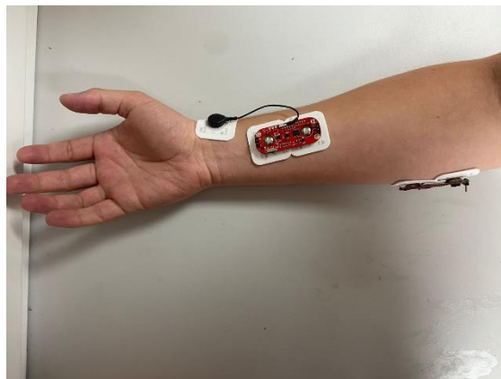
Ilustración 9 Ubicación sensores Myoware dos canales. Fuente: Autor.
