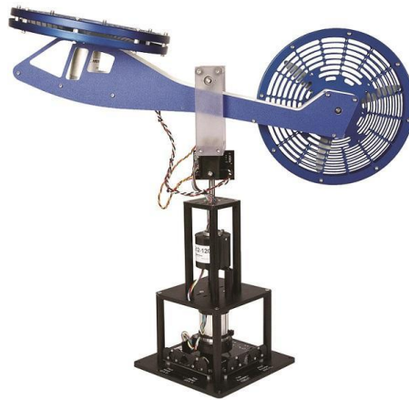
Fig. 1. Helicóptero de 2 DOF – empresa Quanser (Quanser, 2006)
