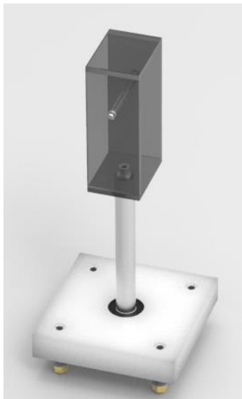
Fig. 8. Ubicación de la caja de acople para los ejes con la base de soporte (Autor)
