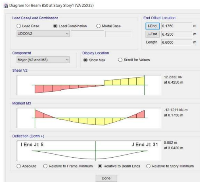
Figura 23 Diagrama de cortante , momento y deflexion de la viga Va-1
