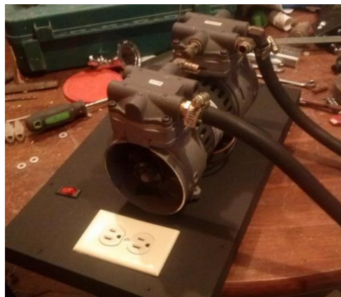
Figura 5. Montaje del compresor de ½ HP.
