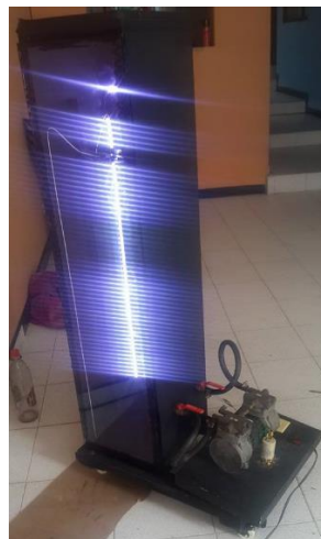
Figura 8. Cámara de vacío con los sistemas de control y luz instalados.
