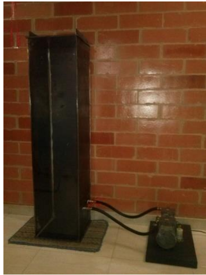
Figura 4. Cámara de vacío terminada.
