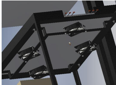
Figura 12. Montaje de ventiladores inferiores para refrigeración de las placas inferiores.
