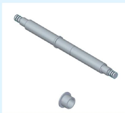
Figura 6. Modelo de tanque impreso y diseño CAD del kit AXLE / BUSHING LOWER DRAG STRUT.
