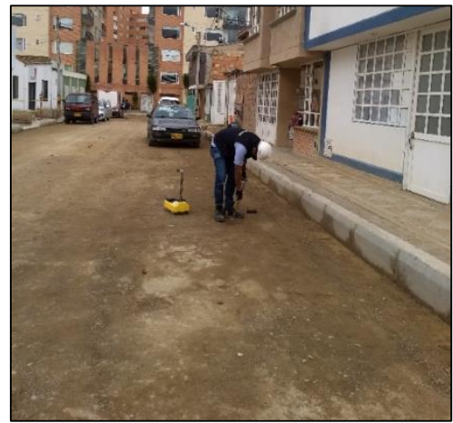
Ilustración 14. Toma de densidades En Base granular, por densímetro nuclear.
