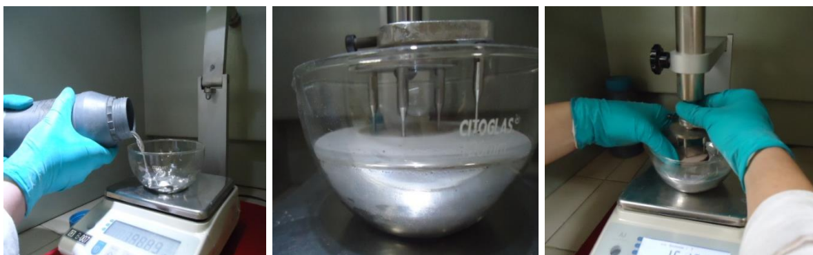
Figura 9. Densímetro utilizado para estimar la densidad aparente de las muestras. Fotografías del Autor
