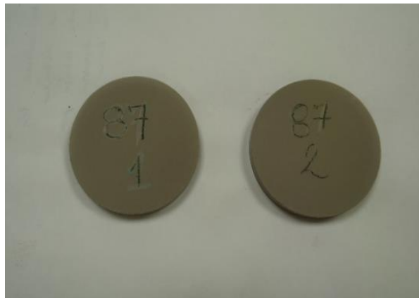
Figura 3. Plaquetas humedecidas con agua residual. Fotografía del Autor.
