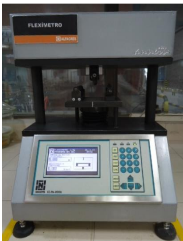
Figura 13. Flexímetro del laboratorio central Alfagres S.A utilizado para el análisis de las muestras. Fotografía del Autor.
