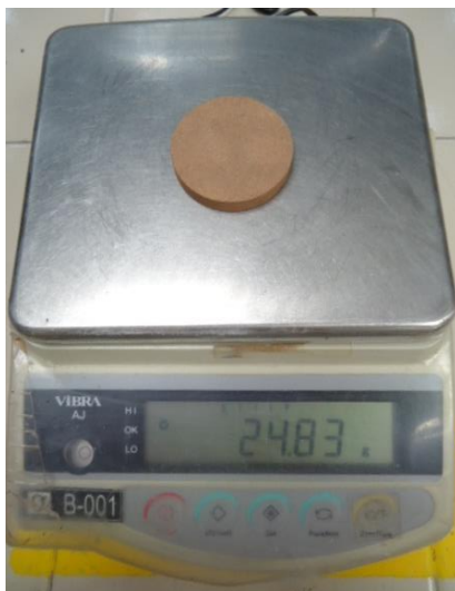
Figura 4. Balanza de precisión utilizada para el pesaje de las plaquetas. Fotografía del Autor
