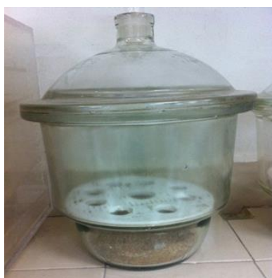
Figura 10. Desecador utilizado para mantener las muestras secas. Fotografía del Autor
