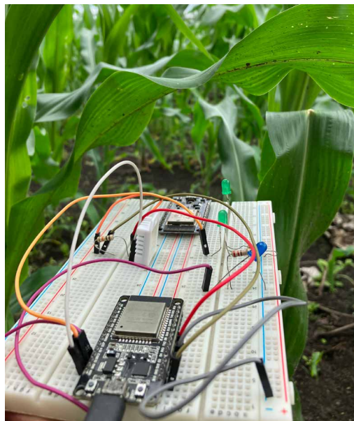
Figura 1-4. Automatización a través del microcontrolador ESP32 en cultivo de maíz. Acacias, Meta
