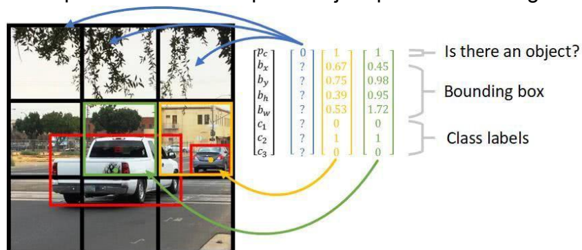
Figura 3.8. Bounding Box de la estructura YOLO
