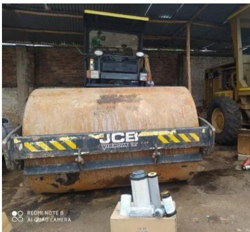
Figura 21. Cambio de aceites, filtros y otros Vibrocompactador
