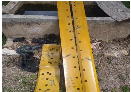
Figura 28. Cambio de Cuchillas Motoniveladora
