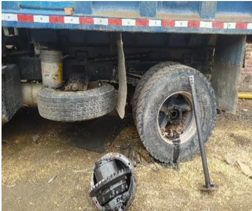
Figura 25. Cambio de Transmisión Volqueta Azul
