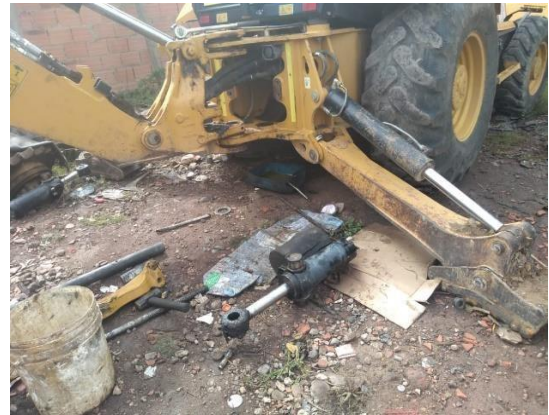
Figura 26. Reparación Bujes de giro Retroexcavadora Caterpillar
