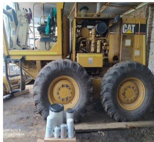
Figura 22. Cambio de aceites, filtros y otros Motoniveladora
