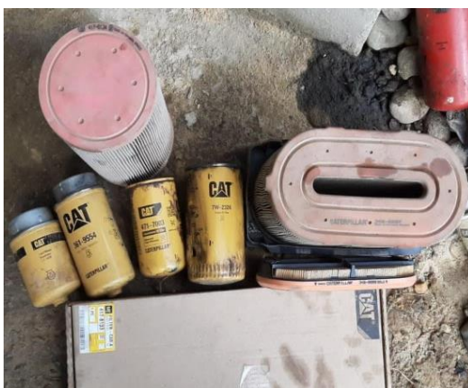
Figura 23. Cambio de aceites, filtros y otros Retroexcavadora Cat
