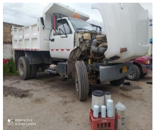
Figura 24. Cambio de aceites, filtros y otros Volqueta Blanca
