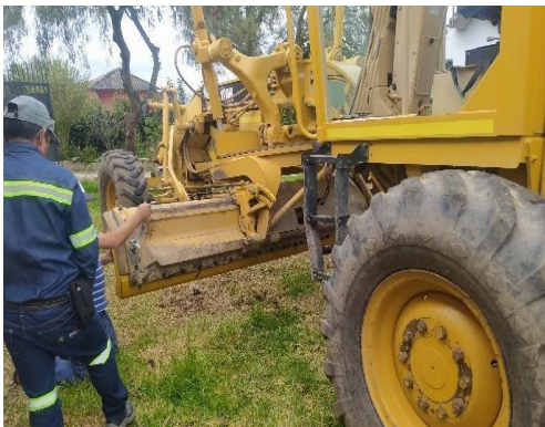
Figura 27. Cambio de Cuchillas Motoniveladora
