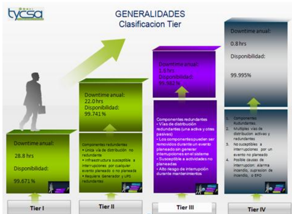
Figura #4 Clasificación DataCenter – Tomada de TYCSA
