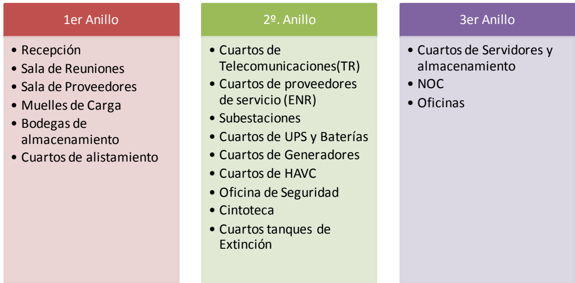
La figura # 7. Muestra el resumen de las áreas diseñadas en el Data Center.
