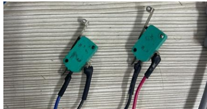
Figura 36. Finales de carrera y tornillo de indicación de proceso
