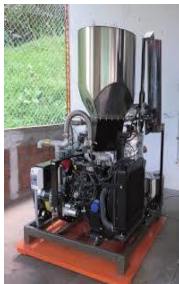
Ilustración 13. Ejemplo de gasificador downdraft.
