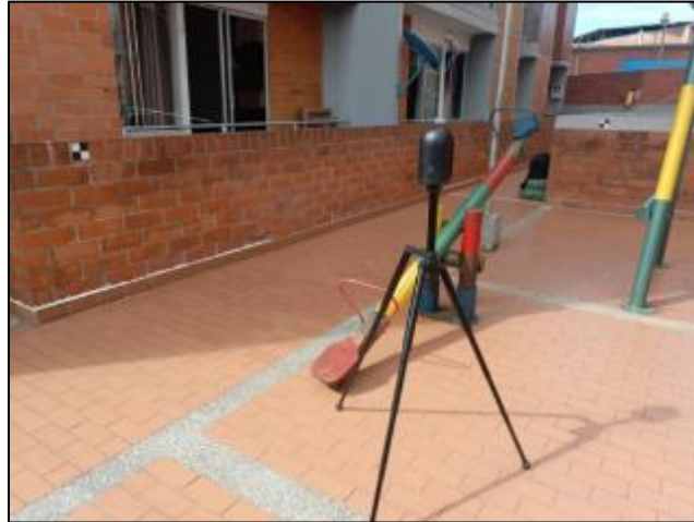
Figura 11. Escáner láser leica BLK360
