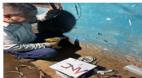
Figura 2. Procedimiento de muestreo estratificado para la caracterización físico-mecánica de la tierra en laboratorio.
