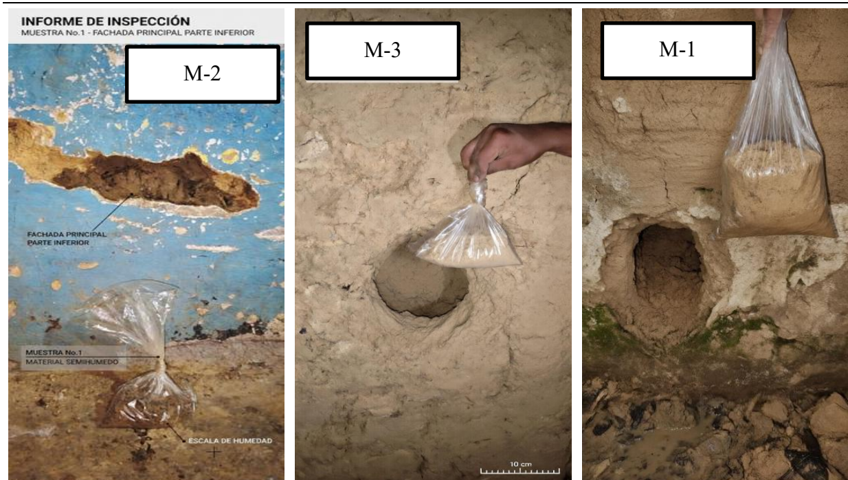
Figura 3. Proceso de extracción de muestra alterada representativa en el muro de tapia pisada de la fachada norte. Las muestras del material recolectado en bolsa hermética y etiquetada, conforme a ASTM D1452.
