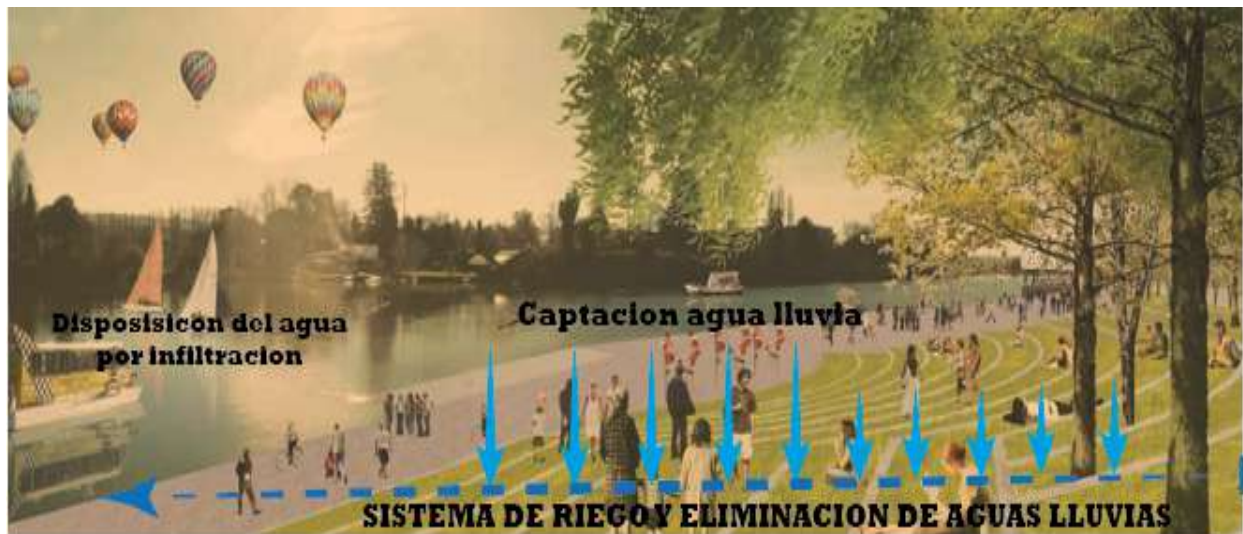
Figura 20. Sistema de riego y eliminación de aguas lluvias
