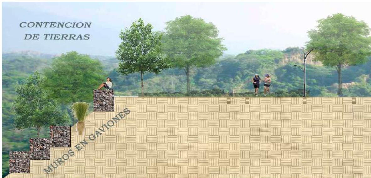
Figura 32. Contención en muros gaviones.
