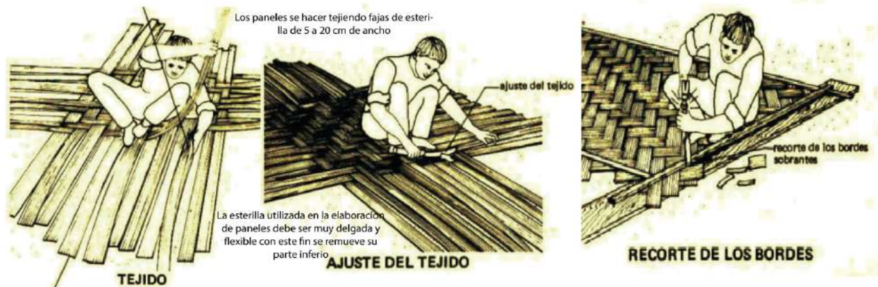
Figura 37. Instalación de paneles de esterilla de las cubiertas
