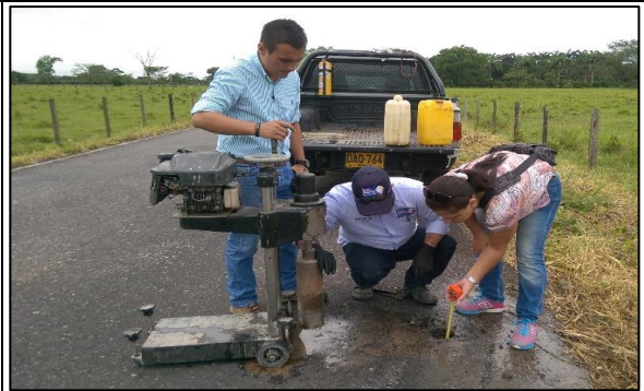
Fotografía 9 Medición de profundidad de la extracción realizada. Foto tomada por los autores del estudio.
