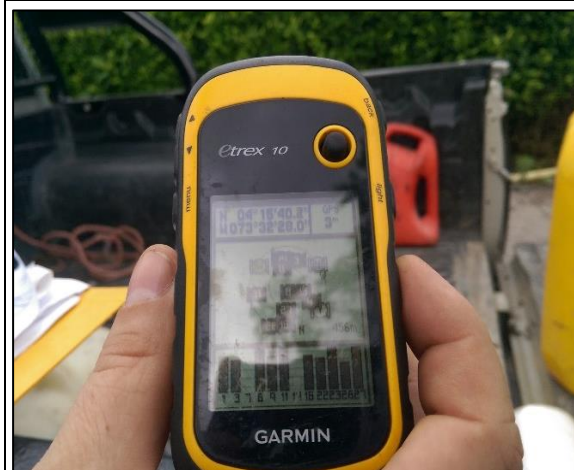
Fotografía 12 Materialización de puntos de extracción por medio de GPS. Foto tomada por los autores del estudio.
