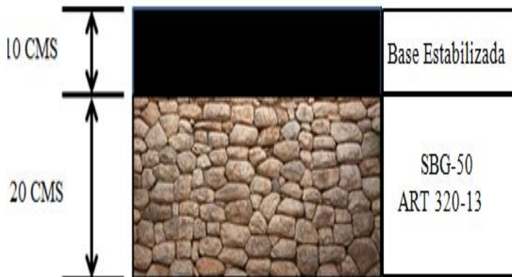
Figura 17 Estructura del pavimento, alternativa 2. Fuente Propia.
