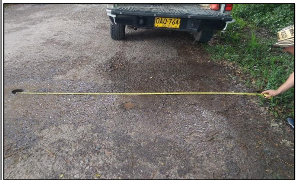
Fotografía 11 Toma de distancia del sitio de extracción del núcleo hasta el extremo de la vía. Foto tomada por los autores del estudio.
