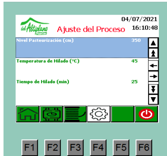
Figura 17: Configuración de las variables interfaz HMI. Fuente: Autor.
