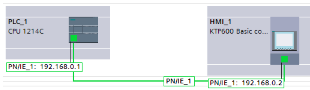
Figura 10: Conexión de dispositivos. Fuente: Autor.
