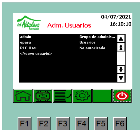
Figura 16: Configuración de usuarios interfaz HMI. Fuente: Autor.
