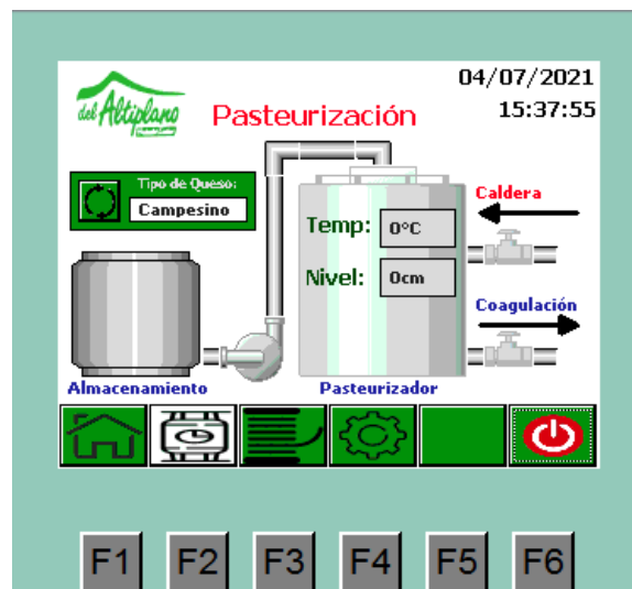
Figura 14: Etapa de pasteurización interfaz HMI. Fuente: Autor.
