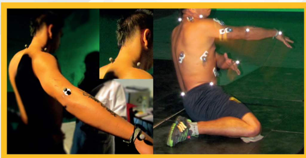
Figura 8: [Rangos De Movimiento Articulación De Hombro Y Codo (Ubicación de marcadores y toma de datos)]
