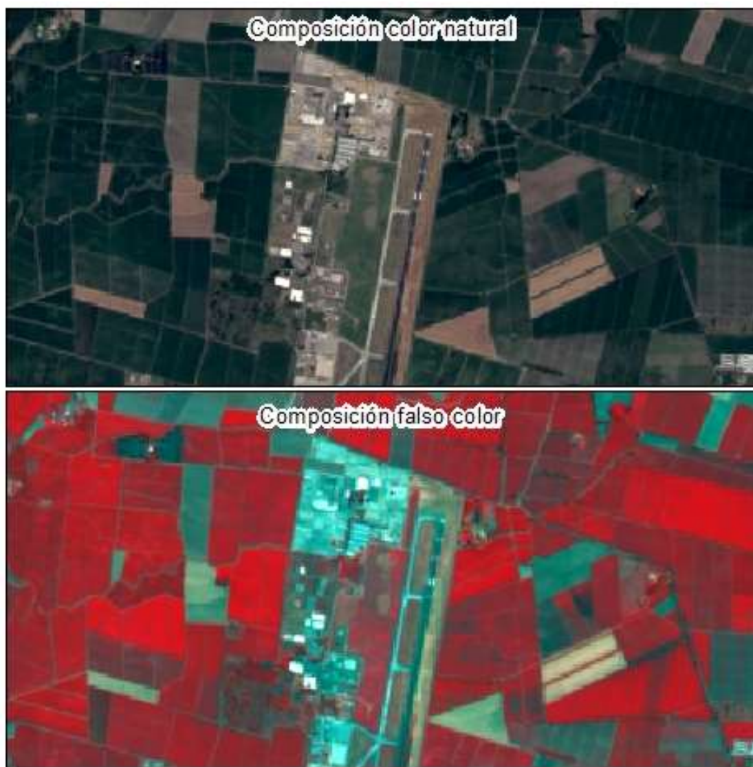
Imagen 9 Identificación cultivos de caña, según geometría, radiometría y textura.
