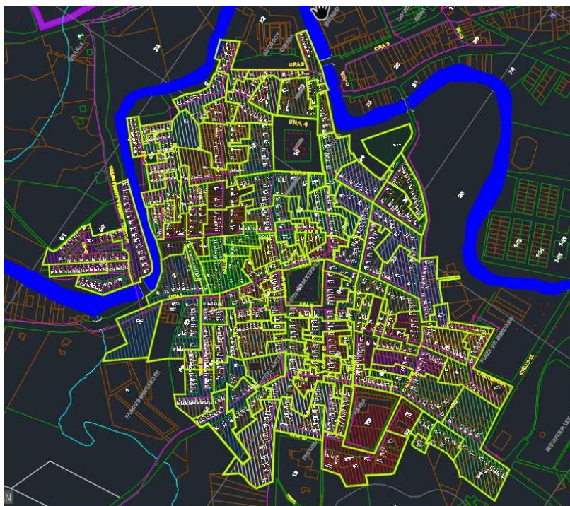
Figura 29 Muestra agrupación celdas 24 Abonados para la formación celdas de 96 abonados correspondiente a cada uno de los puertos GPON.
