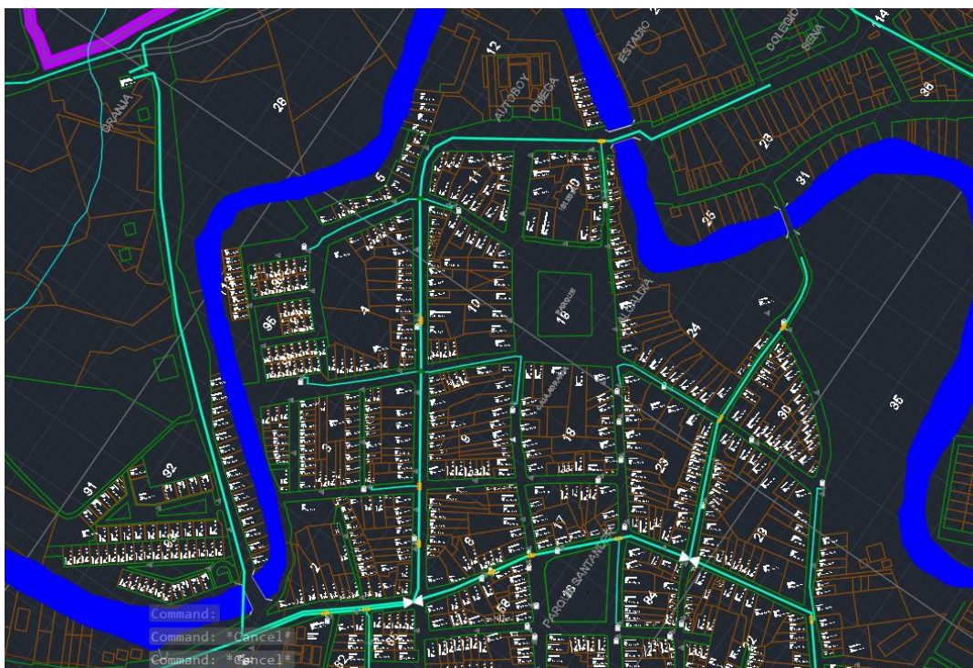
Figura 34 Sangrado en fibra respectivo para un aproximado de 1450 usuarios basado en la fibra actual.
