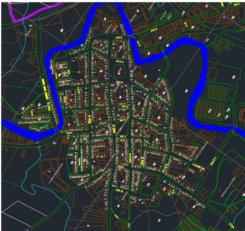
Figura 27 Identificación catastral, infraestructura aérea (infraestructura de red eléctrica) zona centro municipio de Monquirá finalizado.
