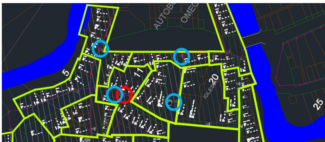
Figura 32 Señalización ubicación spliter "X4" y spliter "X32"
