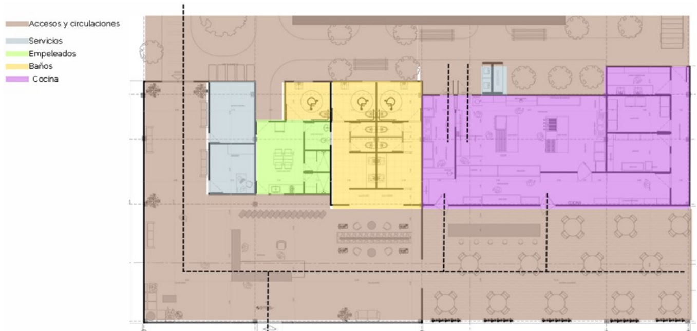
Figura 45. Circulaciones recepción en planta
