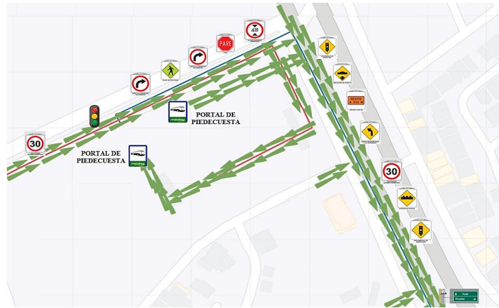
Figura 26. Mapa de la ruta APD7 con su respectiva señalización vial, semaforización y puntos de parada.
