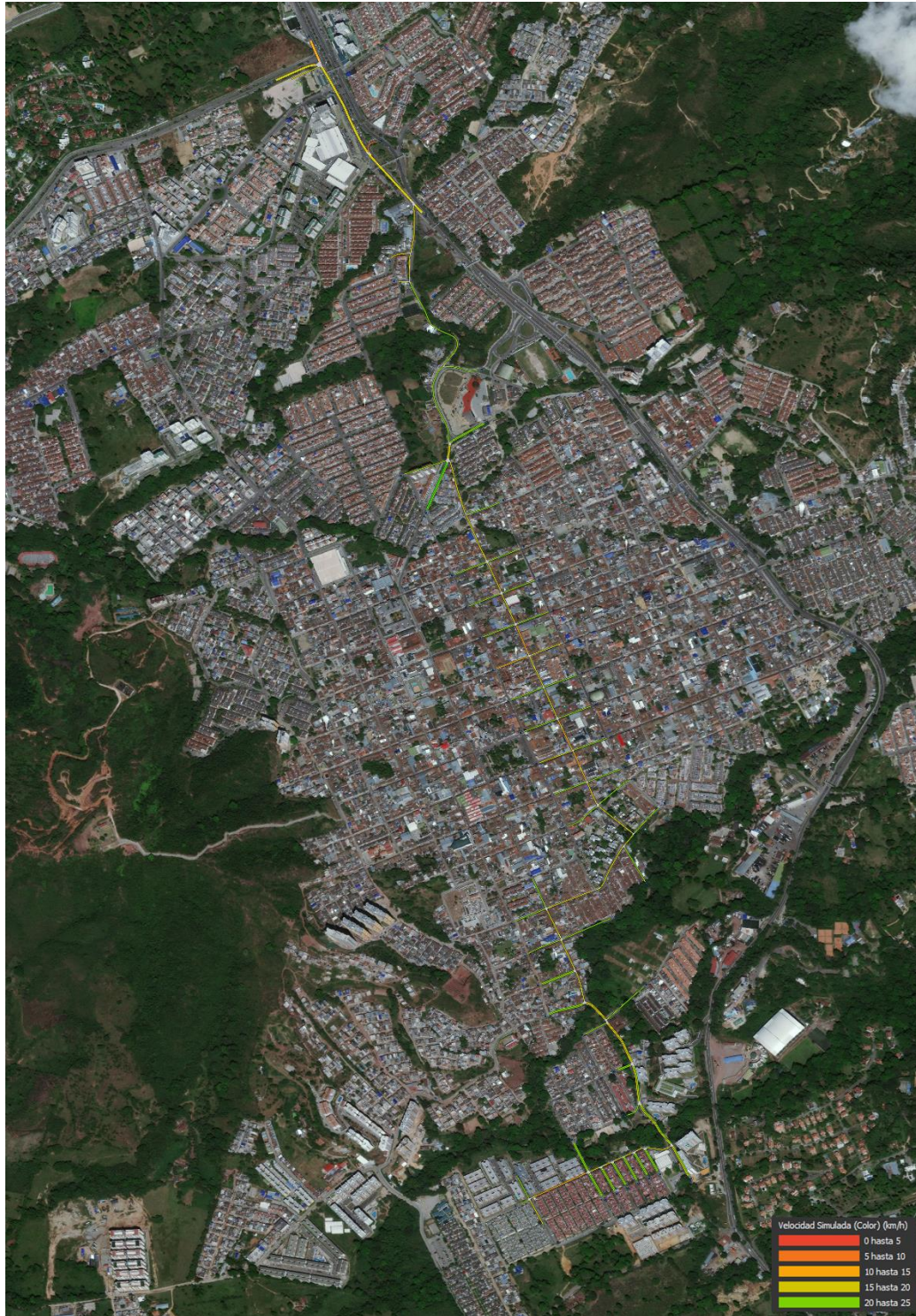
Figura 86. Mapa de velocidades [velocidad general (todos los vehículos) de la red vial – el alimentador realiza sus respectivas paradas]. Elaboración propia en Aimsun Next.
