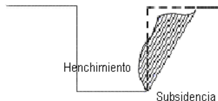
FIGURA 4. SUBSIDENCIA Y HENCHIMIENTO
