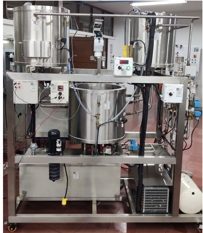
Fig. 1. Planta de proceso de mezclado térmico.
