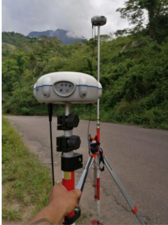
Figura 20. Posicionamiento de puntos topográfico base. Fuente: Propia
