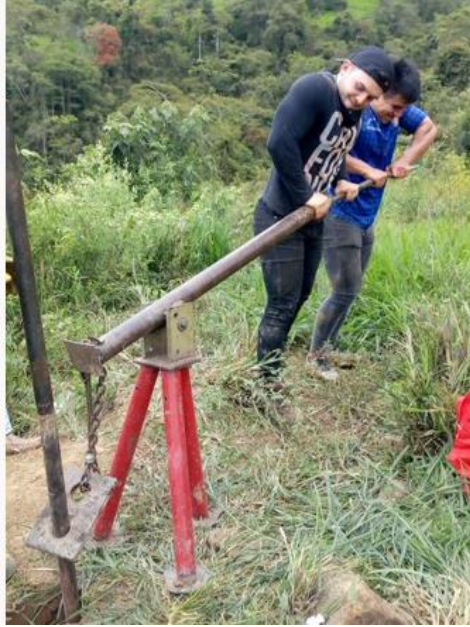
Figura 37. Equipo SPT usado para la exploración manual. Fuente: Propia
