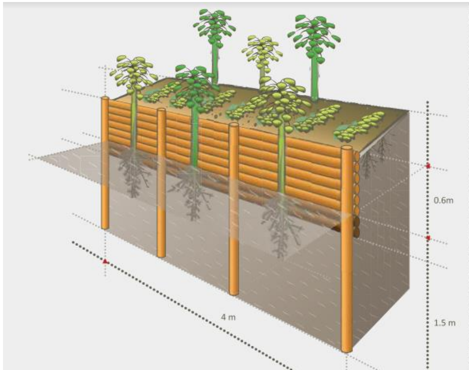
Figura 70. Trinchos escalonados para el control de la erosión en arcillas. Fuente: CAR
