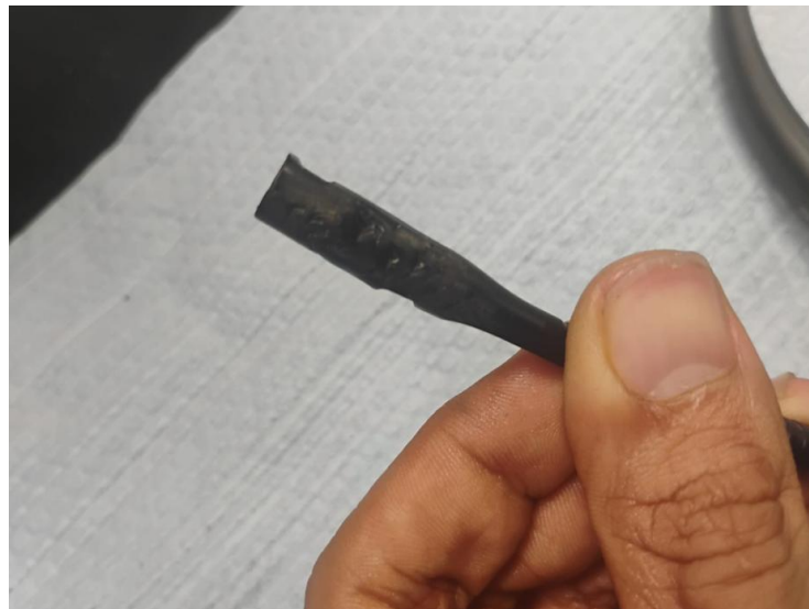
Figura 6. Daño visible por mal uso en micrófono de diadema
