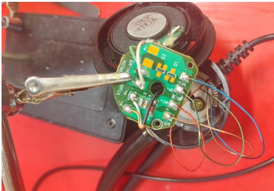
Figura 7. Reparación de micrófono y cambio de cable liso en una diadema HW510
