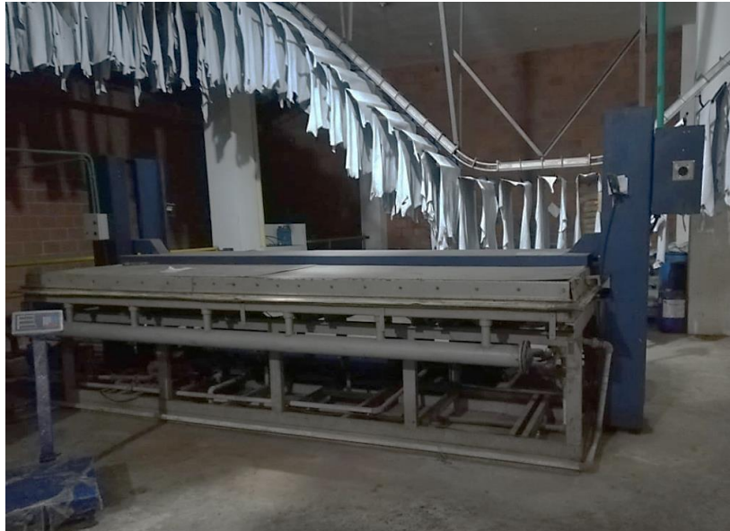
Figura 9. Máquina al Vacío Necesaria para la Etapa de Secado
