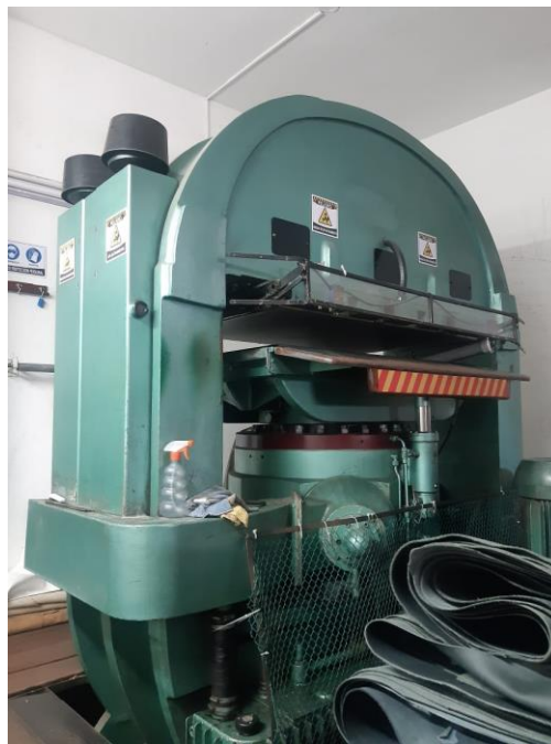
Figura 12. Plancha Industrial, Máquina Necesaria para la Etapa de Acabado
