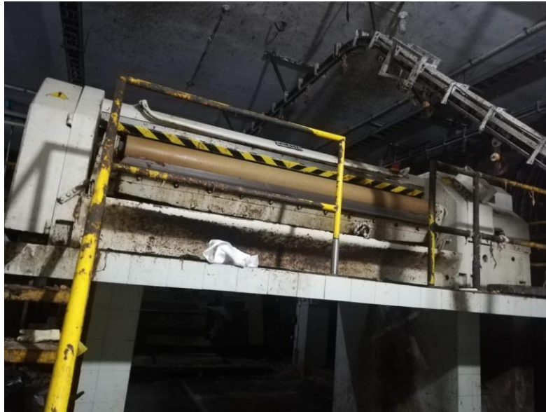
Figura 7. Máquina Descarnadora Necesaria para la Etapa Inicial del Proceso
