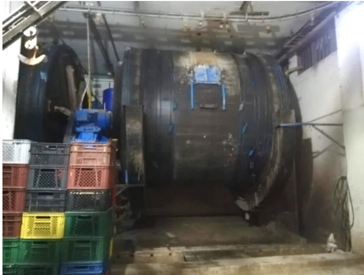
Figura 3. Bombos o Fulones Necesarios para la Etapa de Curtido y Recurtido.
