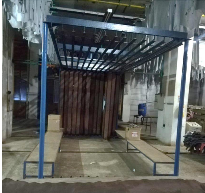
Figura 11. Toggling, Máquina Necesaria para la Etapa de Acondicionado
