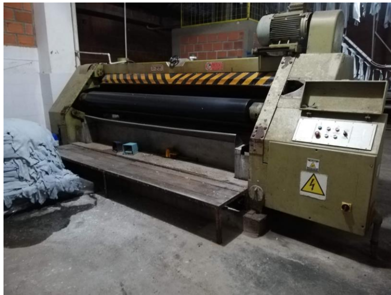
Figura 6. Máquina Estiradora Necesaria para la Etapa de Ecurrido y Secado
