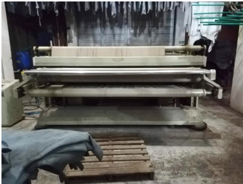
Figura 10. Molliza, Máquina Necesaria para la Etapa de Acondicionado
