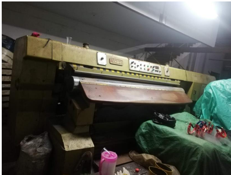
Figura 8. Máquina Rebajadora Necesaria para la Etapa de Recurtido
