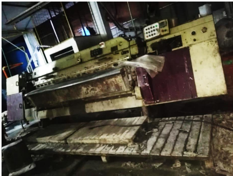
Figura 4. Máquina Divisora Necesaria para la Etapa de Curtido
