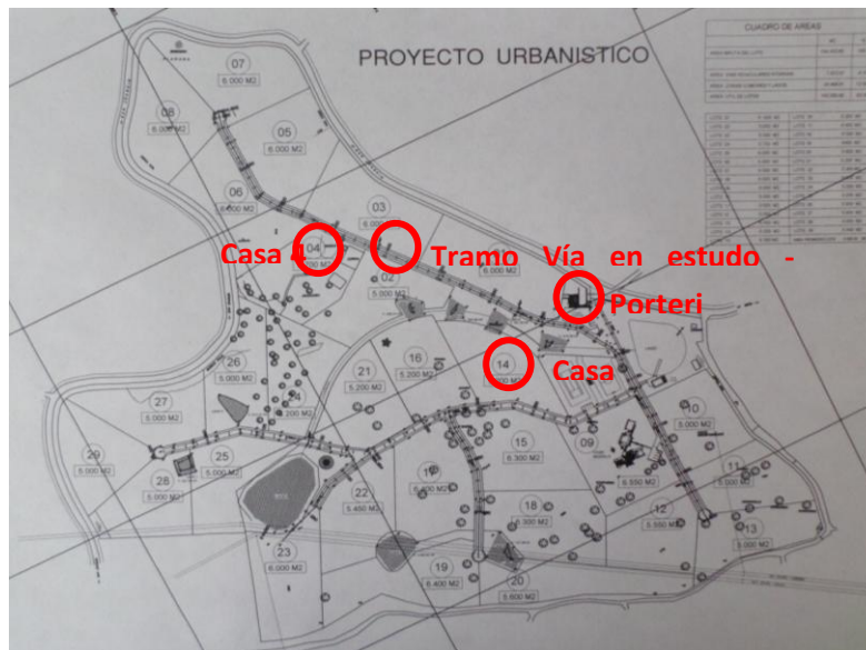
Figura No. 41 ubicaciones de algunas construcciones afectadas como consecuencia de las arcillas expansivas
