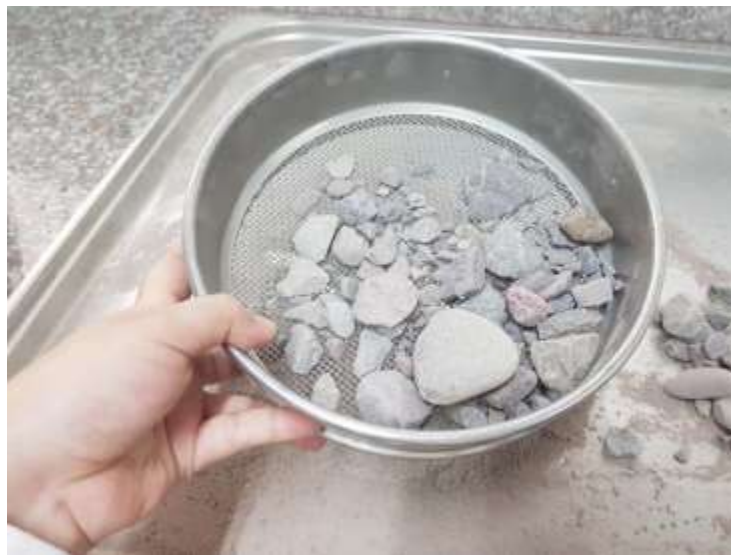
Figura 8.7 Muestra pasada por el tamiz N°12 Fuente: Autores
