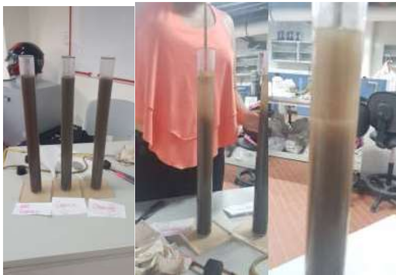
Figura 8.14 Resultados obtenidos de la relación arena-arcilla para el ensayo equivalente de arena Fuente: Autor
