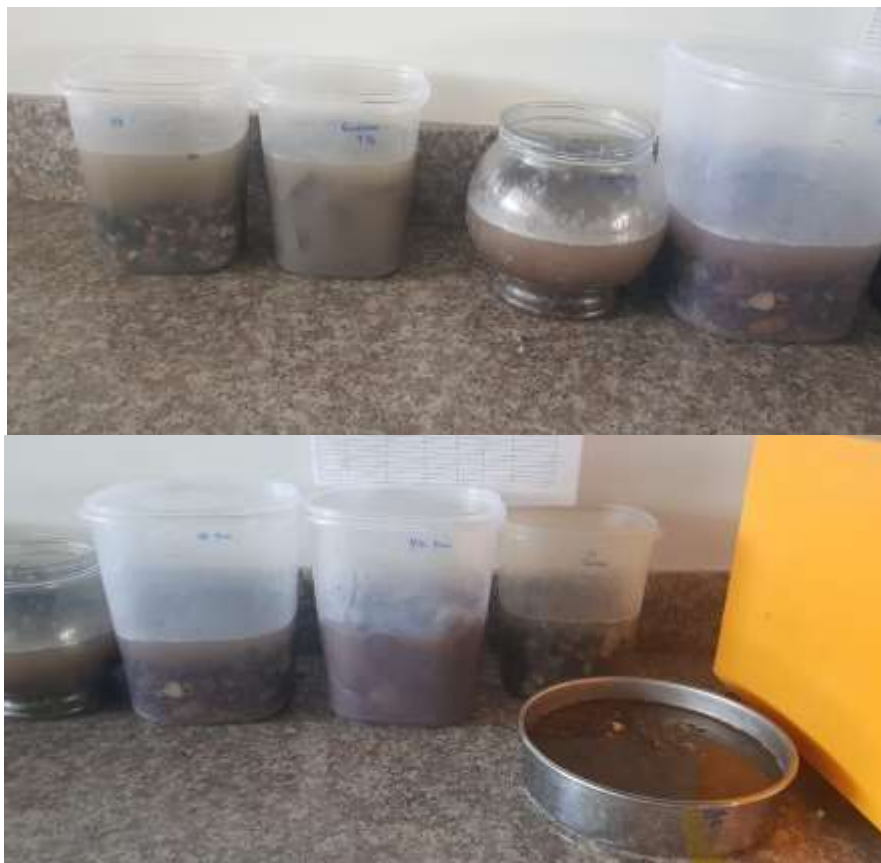
Figura 8.16 Material introducido en agua destilada Fuente: Autor
