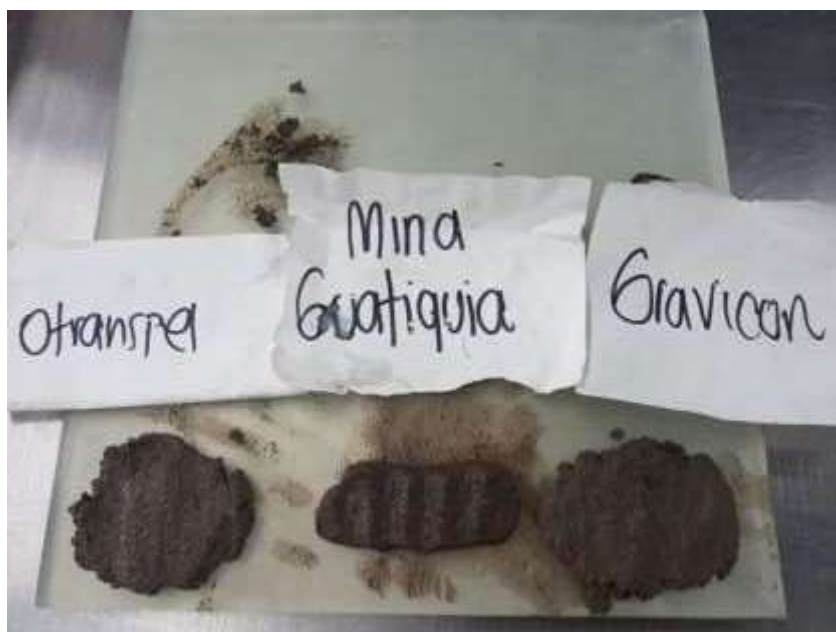
Figura 8.12 Resultados del material usado para el ensayo índice de plasticidad Fuente: Autor
