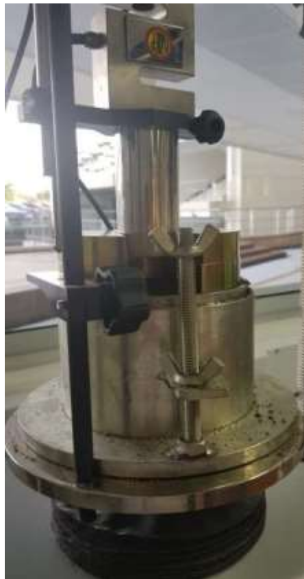
Figura 8.21 Demostración de la realización del ensayo CBR Fuente: Autor
