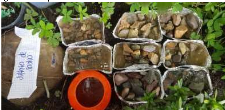
Figura 8.10 Material sumergido dentro del sulfato de Sodio Fuente: Autor
