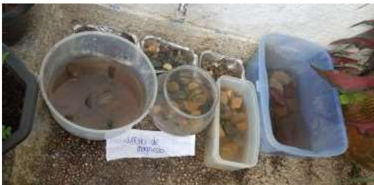
Figura 8.11 Material sumergido dentro de sulfato de Magnesio. Fuente: Autor
