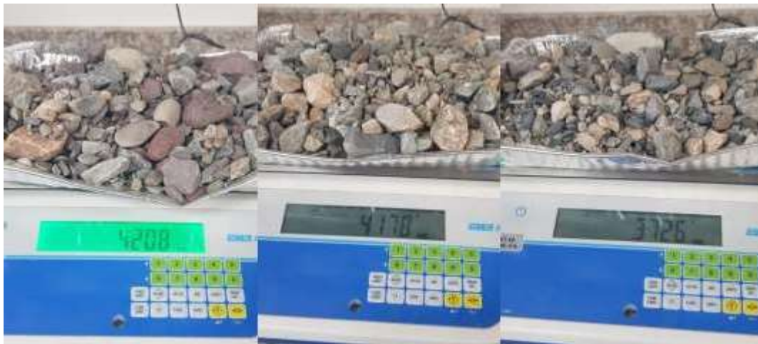
Figura 8.9 Resultados obtenidos del ensayo Desgaste de los Ángeles de las canteras Mina Guatiquía, Otranspel y Gravicon respectivamente Fuente: Autor
