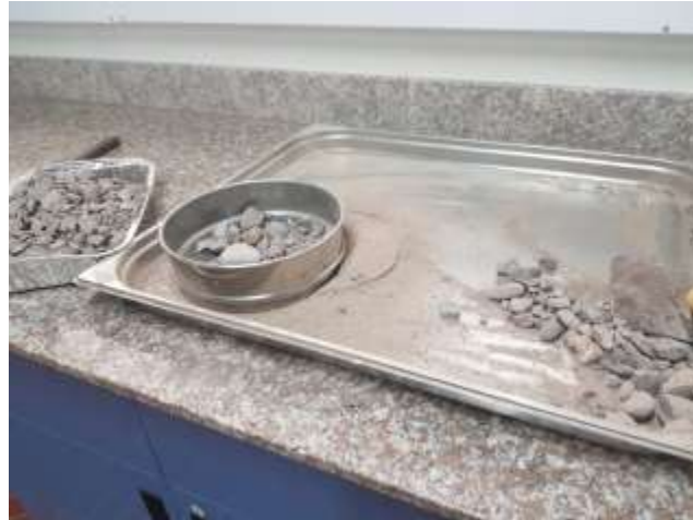
Figura 8.6 Material debidamente sacado de la máquina de los Ángeles Fuente: Autores
