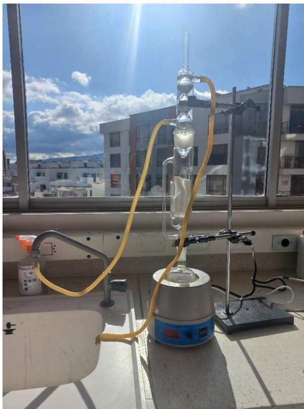
Figura 16 Montaje equipo de destilación Soxhlet
