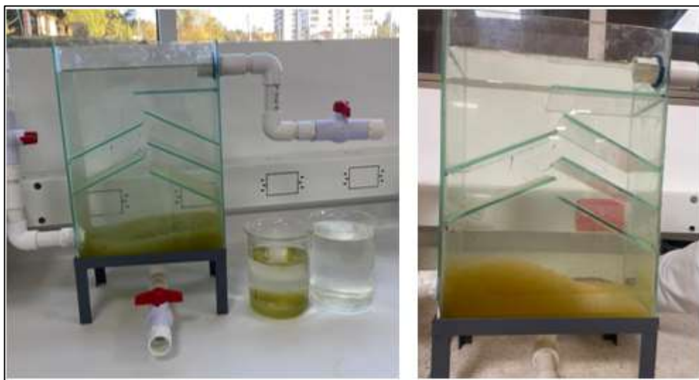
Imagen 67 Unidad de Floculación Construida.
